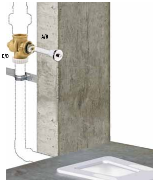
Válvula de Descarga Pasante (válvula instalada externa a la pared)
