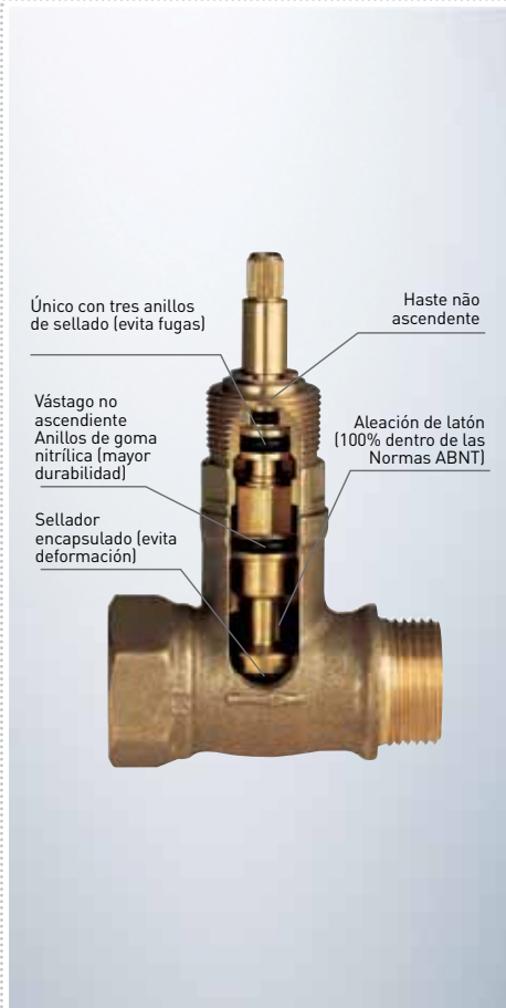
Válvula de Presión DocolBase en Corte
